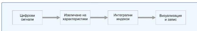
Фиг.4. Блокова схема на софтуерните средства за анализ и визуализация
