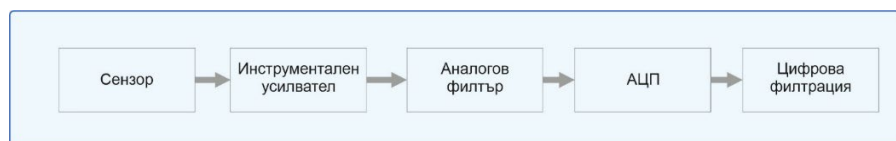
Фиг. 3. Функционална схема за аналогоцифрово преобразуване с предварителна обработка
