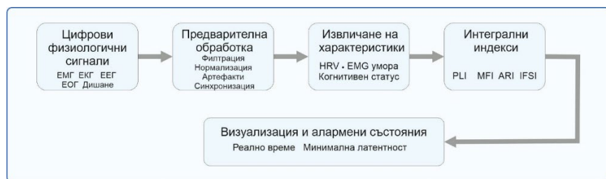
Фиг. 7. Функционалната архитектура на реалновремевия софтуерен слой
