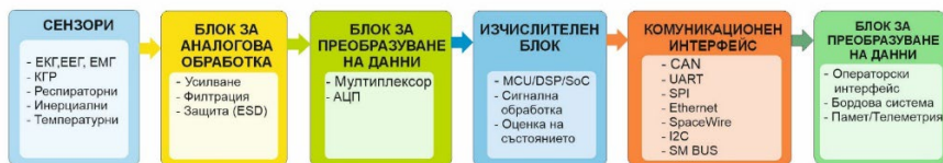
Фиг. 1. Архитектура на апаратните системи за сбор и обработка на данни
