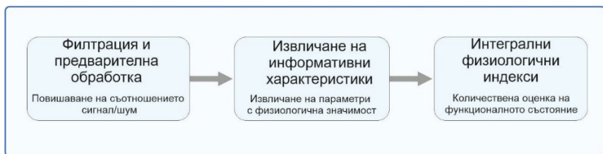
Фиг. 5. Примерна конфигурация за обработка на физиологичните сигнали
